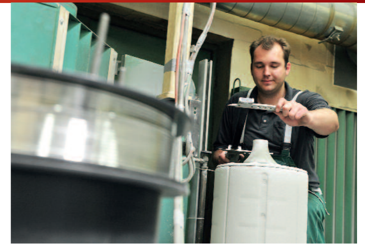
Jürgen Steiner arbeitet ebenfalls in der Abteilung Thermisches Beschichten. Er bedient die kombinierte Anlage Plasmaspritzen/Hochgeschwindigkeitsspritzen für große Bauteile.
